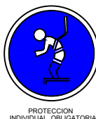
PROTECCION INDIVIDUAL OBLIGATORIA CONTRA CAIDAS
